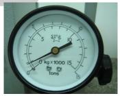
油壓旋鈕 逆時鐘轉半圈,使壓力下降至0。 註:洩壓時,逆時鐘旋轉半圈即可,以免 旋鈕脫落,油外洩。 (三)取片 取片裝置: 將壓片後的模具倒放,並依序於其上放置 空心圓環及墊高平台,轉動固定旋鈕將模 具固定鎖緊。 油壓旋鈕順時鐘鎖緊,手扶模具,施壓把 手前後推動,使油壓平台向上昇頂出超導 片(頂出時會有"喀拉"一聲)。 頂出超導片後,油壓旋鈕逆時鐘轉半圈以 洩壓;並鬆開上方固定旋鈕,將模具等取 出。 完成壓片之樣品。
