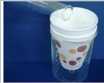
11. 稱取約 3 g 的  $\text{NH}_4\text{Cl}$  固體，記錄精確重量，然後全部加入卡計中。
