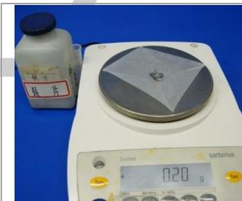
15. 反應完全後，將溫度計與保麗龍杯洗淨擦乾，重新再量取約 100 mL 之 1.0 M HCl 置於卡計中，精確稱取約 0.7 g 氧化鎂與其反應，並決定反應的平衡溫度。
