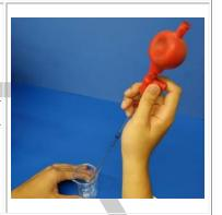
洗淨一支 25 mL 滴定管,以約 5 mL 之 0.020 M KSCN 標準濃度溶液潤洗 2 次後再裝滿之,調整並排除滴定管中之氣泡後,讀記溶液之初體積 5. (Vi)至 0.01 mL。
