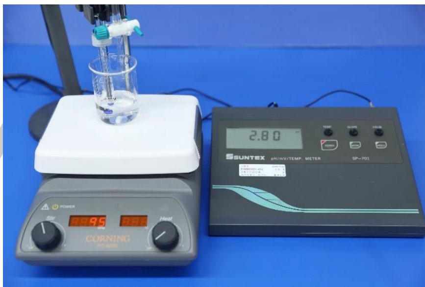
圖 5 酸鹼度測定計與滴定裝置
