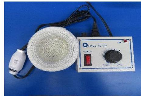
左為加熱包 右為加熱溫度控制器
