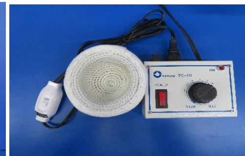
左為加熱包 右為加熱溫度控制器
