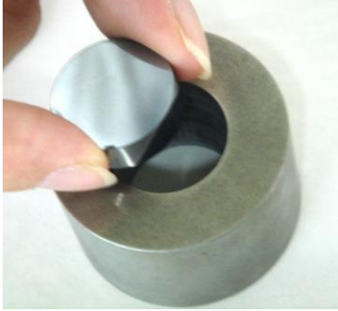
下方墊一張稱藥紙 圓片放入模具中 光滑面朝向粉體
