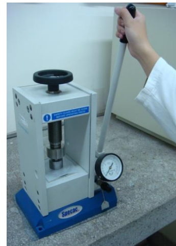
加壓把手前後推動 加壓至 1 \text{ ton/cm}^2
