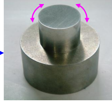
放進圓柱 光滑面朝粉體 左右旋轉使粉末均勻
