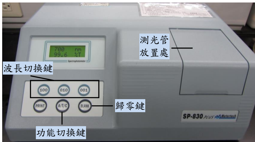
圖 T17-1 SP-830 PLUS/SH-U830(S) 分光光譜儀儀器正面主要控制鈕
